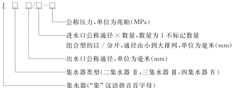
示例 1:进水口公称通径为 2 个 65 mm,出水口公称通径为 100 mm,公称压力为 1.6 MPa 的两集水器,标记为 J II 100/65×2-1.6。
