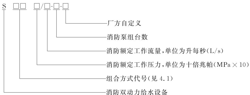
示例: SDC 6/30-2-HT 表示 HT 型电动机泵组和柴油机泵组组合方式的消防双动力给水设备, 消防额定工作压力 0.6 MPa, 消防额定工作流量 30 L/s, 消防泵组为 2 台。
