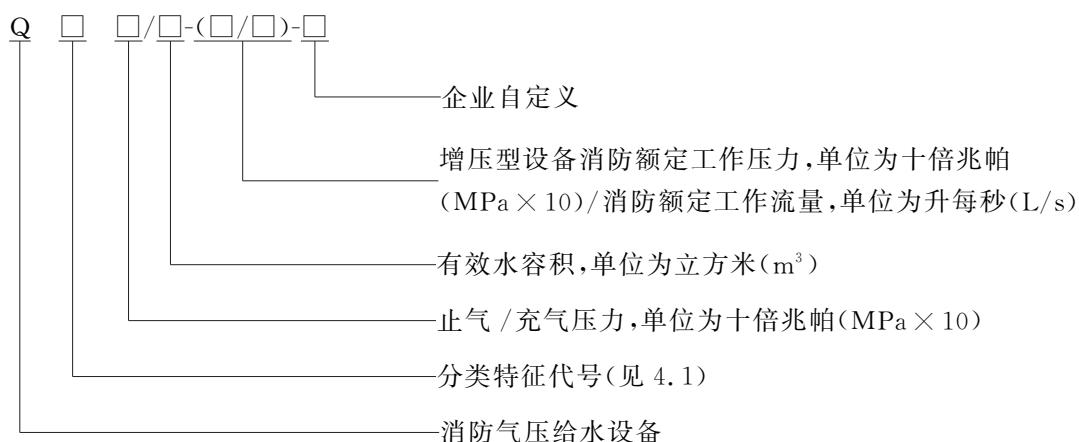
**示例 1:**设备型号 QJB 3/6-ABC 表示 ABC 补气式应急型消防气压给水设备,止气压力为 0.3 MPa,消防有效水容积 6 m<sup>3</sup>。
