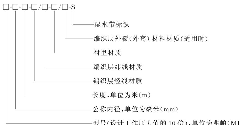
**示例 1：**设计工作压力为 1.0 MPa、公称内径为 65 mm、长度为 25 m、编织层经线材质为涤纶纱，纬线材质为涤纶长丝、衬里材质为橡胶的水带，其型号表示为：10-65-25-涤纶纱 / 涤纶长丝-橡胶。
